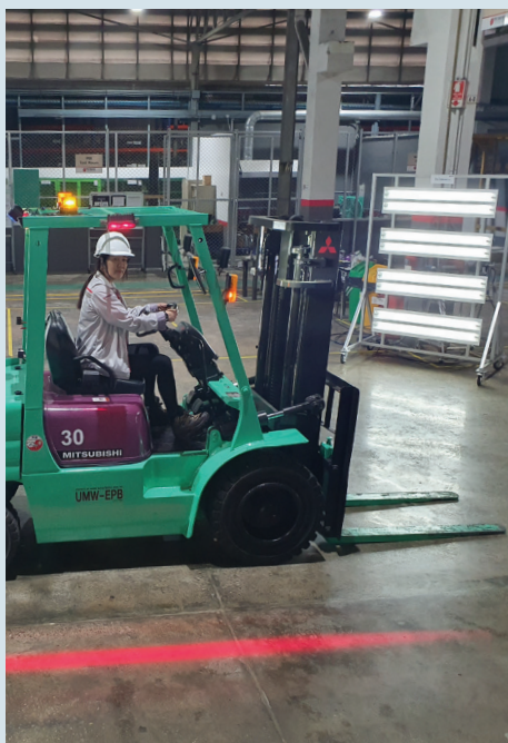
Speed Limit Alarm : ไฟเตือนจำกัดความเร็ว ช่วยลดการเกิดอุบัติเหตุจากการขับเร็วเกินกำหนด
