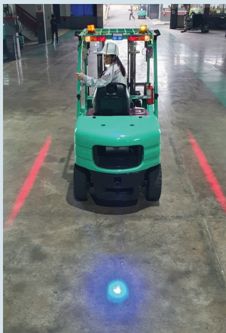
Blue Light : ไฟเตือนสีน้ำเงิน เพื่อให้ผู้ที่เดินอยู่ในบริเวณที่มีการใช้งานฟอร์คลิฟท์ โดยเฉพาะมุมอับหรือมุมอับเห็นไฟเตือนก่อนที่ฟอร์คลิฟท์จะเคลื่อนเข้ามา
