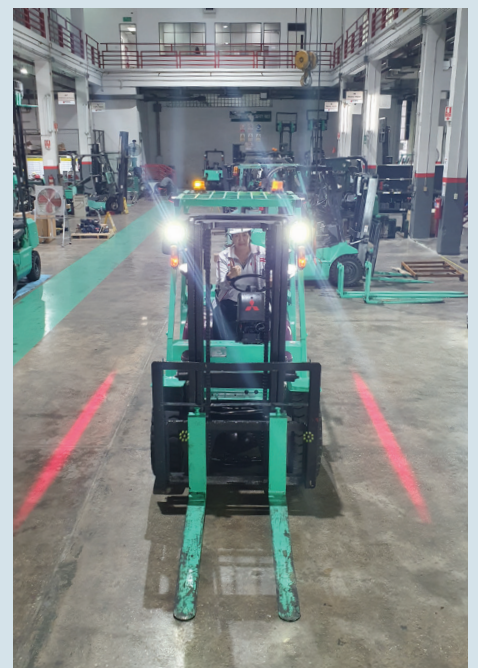
Zone Light : ไฟโซนสีแดง ช่วยให้คนทำงานมองเห็นระยะปลอดภัยจากฟอร์คลิฟท์ เพื่อป้องกันอุบัติเหตุได้เป็นอย่างดี
